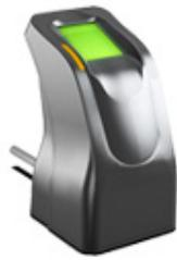
Le scanner d'empreintes digitales ZK4500 sert à capturer l'image des empreintes et les envoie à un ordinateur via l'interface USB pour le développement ultérieur d'un modèle ou comparaisons. Il est utilisé pour l'enregistrement centralisé de systèmes de contrôle d'accès biométrique d'empreintes digitales, ou l'autorisation du doigt dans les demandes de logiciel protégé.
